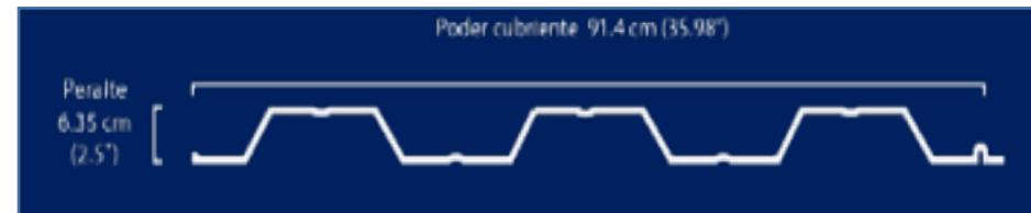
Metal Deck 25 es un perfil diseñado para formar la losa de azotea o entrepiso, se fabrica a partir de rollos de acero de 1.22 m de ancho.
