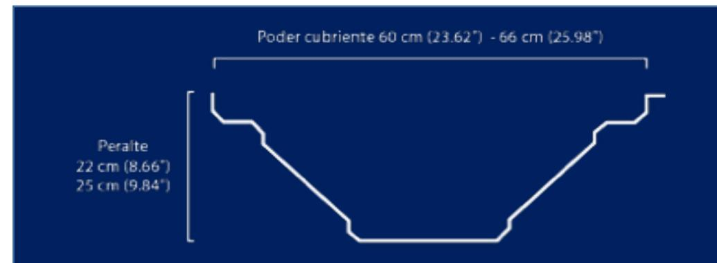
Es un perfil con alta resistencia estructural de tipo engargolable, acanalados especiales su fabricación parte de un rollo de 91.5 cm (36”). Es una lámina que se puede combar y su uso es muy variable para muros, techos, casetas, etc.
