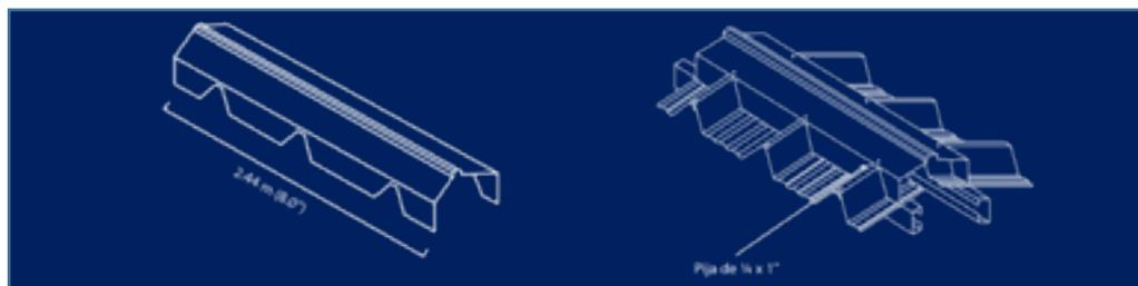
El caballete para lamina R-101 / R-72 / RN-100 / RN-90 es un moldura para cubrir el parteaguas de un techo construido con laminas acanaladas del mismo tipo.
