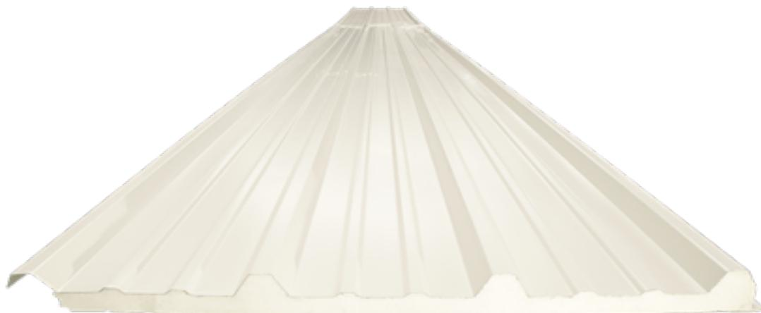
Es un panel aislante para cubiertas de todo tipo de construcción, está compuesto por un núcleo de espuma rígida de poliuretano y dos caras de acero G-37, ambas caras van adheridas químicamente mediante propio núcleo.
