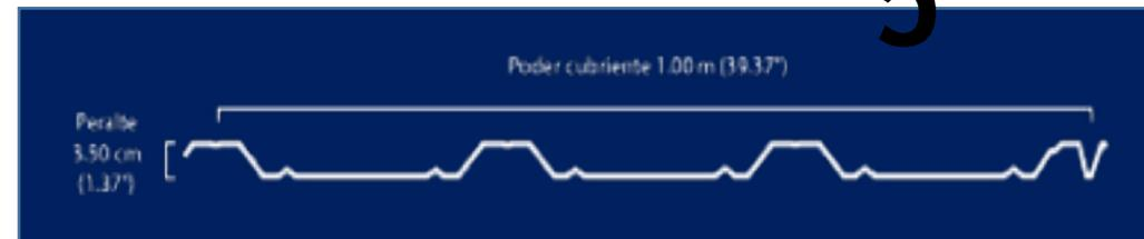
La lámina RN-100/35 se fabrica a partir de rollos de acero de 1.22 m de ancho, su poder de cobertura es de 1m y su peralte de 3.5 cm.
