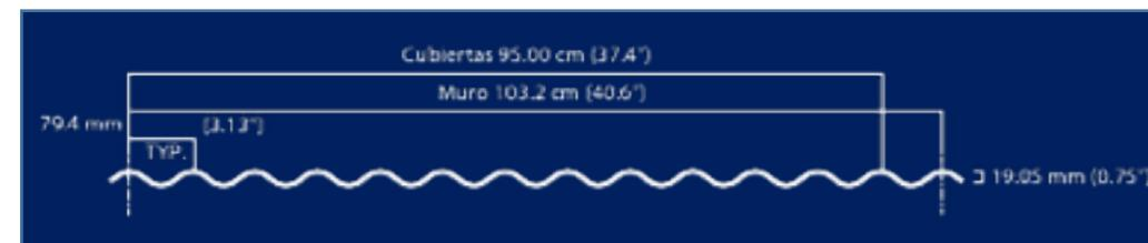
O-100 es un per l ondular (sinusoidal) fabricado a partir de acero galvanizado, Zintroalum o pintado. Por su con duración, este producto es fácilmente estibable.
