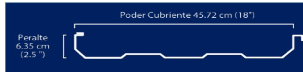
Perfil estructural tipo SSR para cubiertas.
